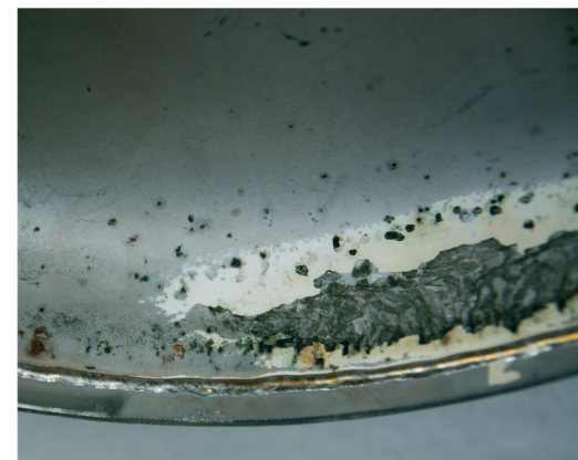
Bild 5: Klörperboden eines Kesselkörpers mit Kesselstein und Korrosionsschäden
